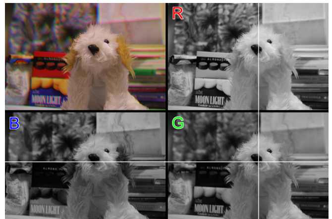
図 4: 色フィルタ付きレンズで撮影した画像と、RGB 別の表示。ずれが分かりやすいように白線を記入してある。焦点を合わせた犬のぬいぐるみにはずれがない。
